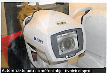
Autorefraktometr na měření objektivních dioptrií
